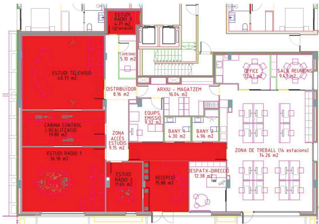
Figura 33. Plano de los recintos de la emisora en las cuales se recomienda instalar el sistema AI-SL14 de Acústica Integral o similar.
