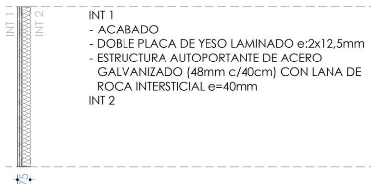
Figura 28. Esquema del trasdosado interior de la medianera original del edificio entre el local de la emisora y una vivienda.
