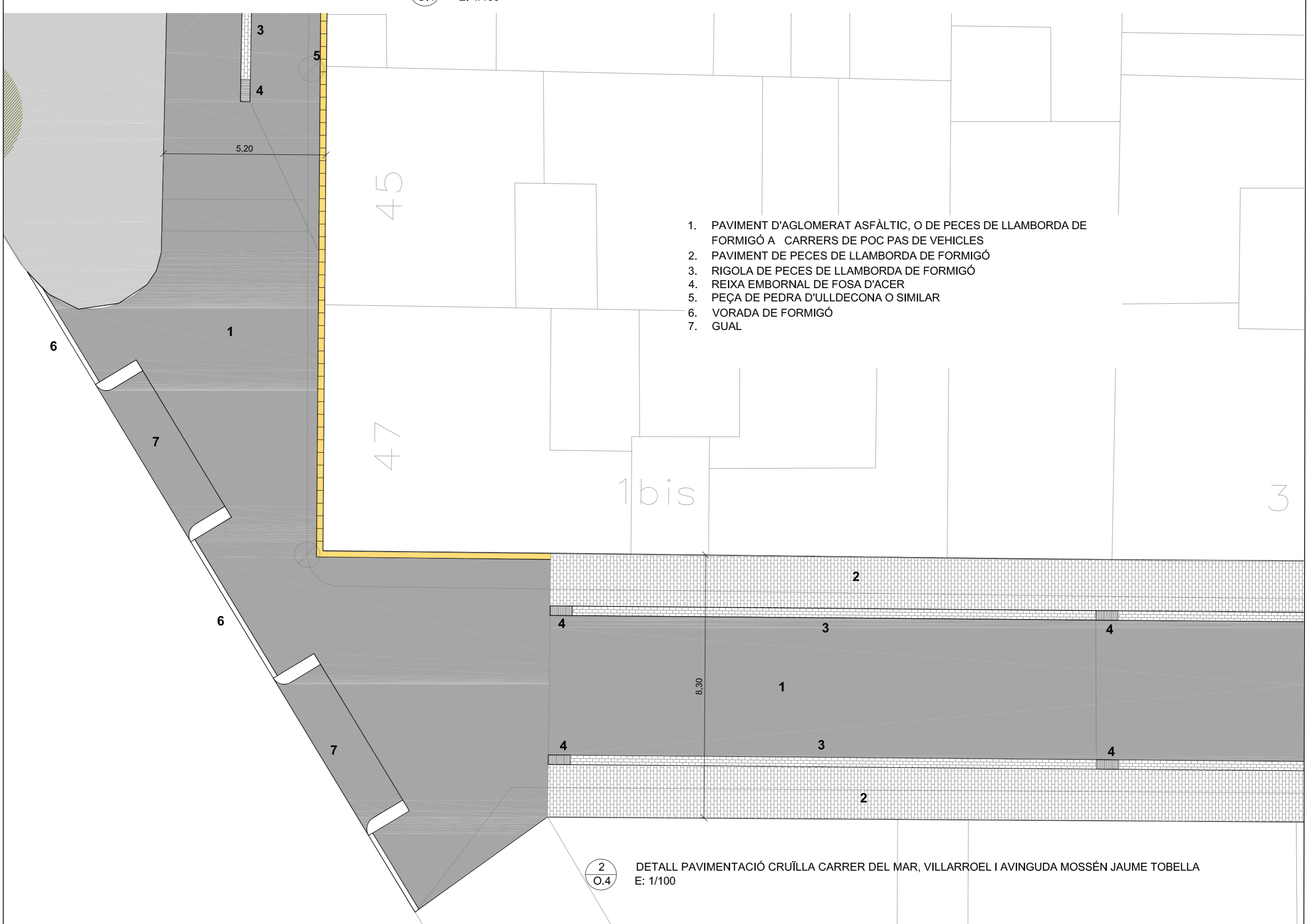
1 0.4 DETALL PAVIMENTACIÓ CRUÏLLA CARRER PRINCIPAL I CARRER DEL MAR E: 1/100
