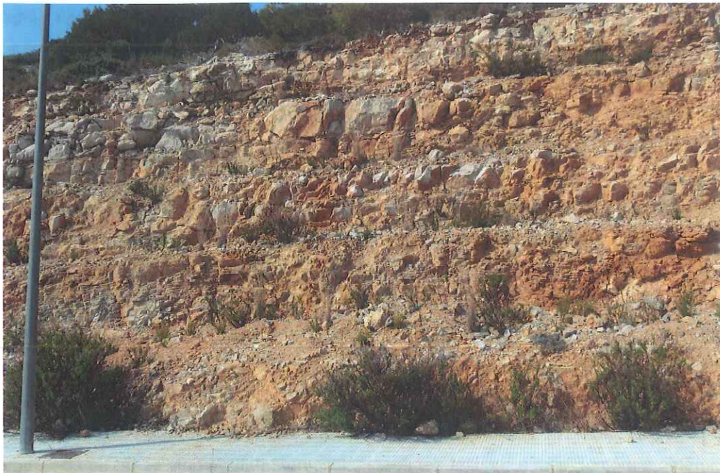
Fotografia 30. Vista de detall de les calcàries cretàiques. S'observa el grau de fracturació, que delimita blocs d'ordre centimètric a decimètric.
